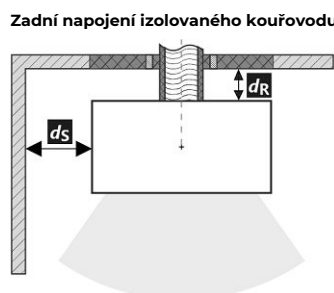
Zadní napojení izolovaného kouřovodu
