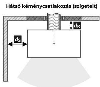
A füstcső áthaladása éghető anyagból készült falon
