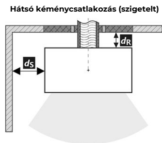
A füstcső áthaladása éghető anyagból készült falon
