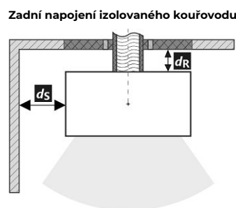
Prostup kouřovodu stěnou z hořlavé hmoty ČSN 06 1008
