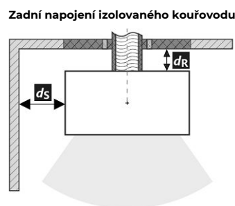
Prostup kouřovodu stěnou z hořlavé hmoty ČSN 06 1008
