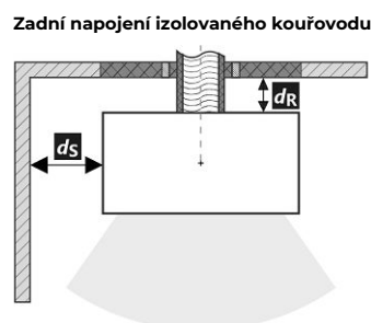
Prostup kouřovodu stěnou z hořlavé hmoty ČSN 06 1008
