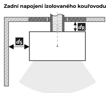
Prostup kouřovodu stěnou z hořlavé hmoty ČSN 06 1008
