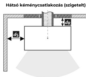
A füstcső áthaladása éghető anyagból készült falon
