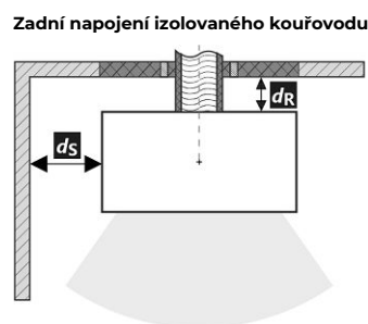
Prostup kouřovodu stěnou z hořlavé hmoty ČSN 06 1008
