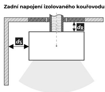
Prostup kouřovodu stěnou z hořlavé hmoty ČSN 06 1008
