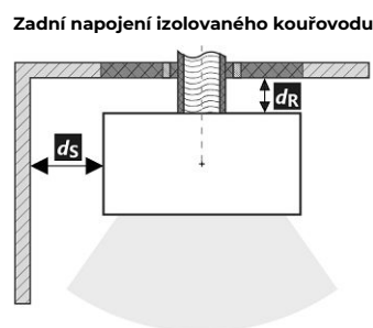
Prostup kouřovodu stěnou z hořlavé hmoty ČSN 06 1008
