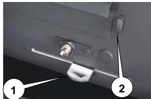
**Primární** Регулятор первичного воздуха используется для регулирования подачи снизу воздуха для горения, который поступает через зольник и колосниковую решетку к топливу. В этой связи следует избегать переполнения зольника, поскольку зола может заблокировать доступ воздуха в топку.
