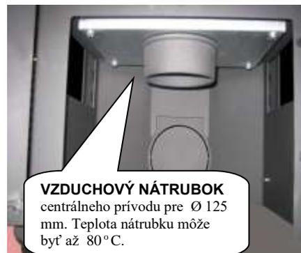
*\* Pri napojení na externý prívod vzduchu (zvonku) sa odporúča inštalovať dvojčinnú klapku so silikónovou manžetou s možnosťou uzavretia prívodu vzduchu. Zabráňte tým vzniku korózie následkom kondenzácie vlhkosti, ak sú krbové kachle mimo prevádzky. Záruka sa nevzťahuje na škody spôsobené následkom korózie!*
