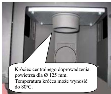
\* Podczas podłączania do zewnętrznego zasilania powietrzem (z zewnątrz budynku) zaleca się zainstalowanie klapy dwustronnego działania z silikonowym mankietem z możliwością szczelnego zamknięcia dopływu powietrza. Zapobiegnie to korozji spowodowanej kondensacją wilgoci oraz wychładzaniu wnętrza budynku, gdy piec nie pracuje. Gwarancja nie obejmuje uszkodzeń spowodowanych korozją!
