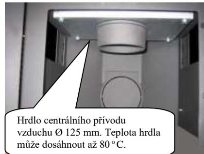
*\*Při napojení na externí přívod vzduchu (zvenku) se doporučuje instalovat dvojčinnou klapku se silikonovou manžetou s možností uzavření přívodu vzduchu. Zabráníte tím vzniku koroze následkem kondenzace vlhkosti, pokud jsou krbová kamna mimo provoz. Záruka se nevztahuje na škody způsobené následkem koroze!*
