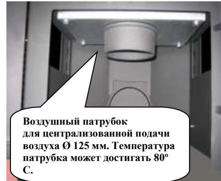
*\*При подключении к внешнему источнику воздуха (снаружи) рекомендуется установить клапан двойного действия с силиконовой манжетой с возможностью закрытия подачи воздуха. Это предотвратит коррозию из-за конденсации влаги, когда печь-камин/каминная топка не работает. Гарантия не распространяется на повреждения, вызванные коррозией!*
