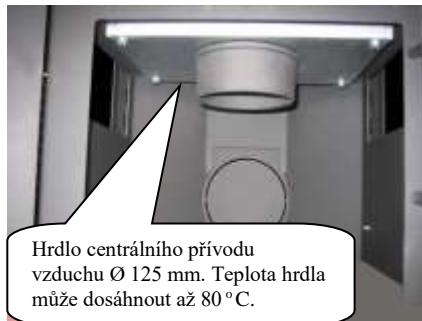
\*Při napojení na externí přívod vzduchu (zvenku) se doporučuje instalovat dvojčinnou klapku se silikonovou manžetou s možností uzavření přívodu vzduchu. Zabráňte tím vzniku koroze následkem kondenzace vlhkosti, pokud jsou krbová kamna mimo provoz. Záruka se nevztahuje na škody způsobené následkem koroze!
