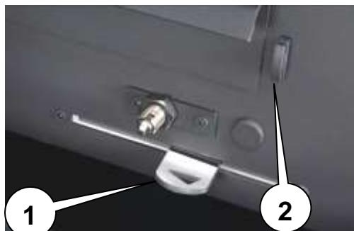
**Primärregulator первого воздуха** используется для регулирования подачи снизу воздуха для горения, который поступает через зольник и колосниковую решетку к топливу. В этой связи следует избегать переполнения зольника, поскольку зола может заблокировать доступ воздуха в топку.
