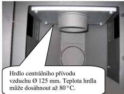
\*Při napojení na externí přívod vzduchu (zvenku) se doporučuje instalovat dvojčinnou klapku se silikonovou manžetou s možností uzavření přívodu vzduchu. Zabráníte tím vzniku koroze následkem kondenzace vlhkosti, pokud jsou krbová kamna mimo provoz. Záruka se nevztahuje na škody způsobené následkem koroze!
