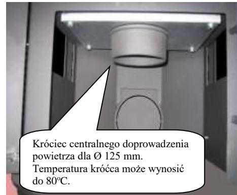
\* Podczas podłączania do zewnętrznego zasilania powietrzem (z zewnątrz budynku) zaleca się zainstalowanie klapy dwustronnego działania z silikonowym mankiem z możliwością szczelnego zamknięcia dopływu powietrza. Zapobiegnie to korozji spowodowanej kondensacją wilgoci oraz wychładzaniu wnętrza budynku, gdy piec nie pracuje. Gwarancja nie obejmuje uszkodzeń spowodowanych korozją!
