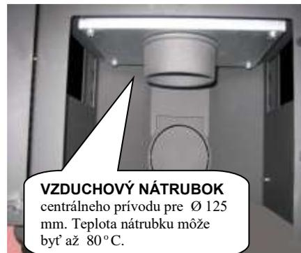
*\* Pri napojení na externý prívod vzduchu (zvonku) sa odporúča inštalovať dvojčinnú klapku so silikónovou manžetou s možnosťou uzavretia prívodu vzduchu. Zabráňte tým vzniku korózie následkom kondenzácie vlhkosti, ak sú krbové kachle mimo prevádzky. Záruka sa nevzťahuje na škody spôsobené následkom korózie!*
