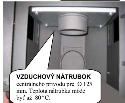
\* Pri napojení na externý prívod vzduchu (zvonku) sa odporúča inštalovať dvojčinnou klapku so silikónovou manžetou s možnosťou uzavretia prívodu vzduchu. Zabránite tým vzniku korózie následkom kondenzácie vlhkosti, ak sú krbové kachle mimo prevádzky. Záruka sa nevzťahuje na škody spôsobené následkom korózie!
