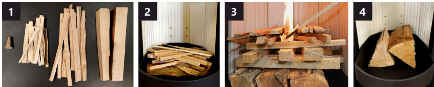
Kép 1 A fa előkészítésének folyamata az égéskamrában
