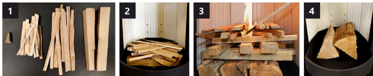
Obr. 1 Postup přípravy dřeva ve spalovací komoře
