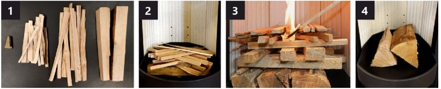
Rys. 1 Proces przygotowania drewna w komorze spalania
