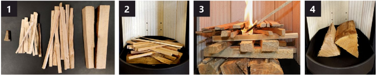
Obr. 1 Postup prípravy dreva v spaľovacej komore
