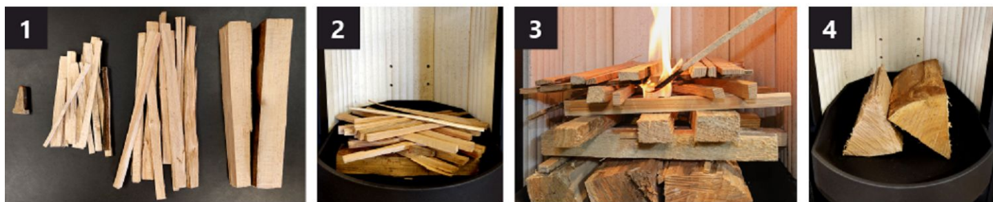
Rys. 1 Proces przygotowania drewna w komorze spalania
